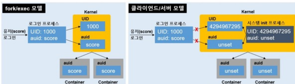
[그림 6] fork·exec 모델 및 클라이언트-서버 모델에서의 UID, auid 설정 동작 방식
