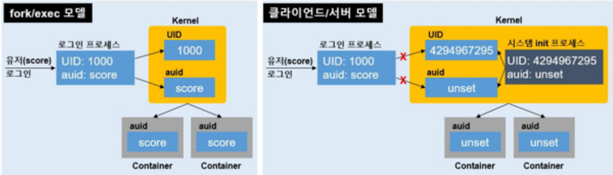
[그림 6] fork·exec 모델 및 클라이언트-서버 모델에서의 UID, audit 설정 동작 방식
